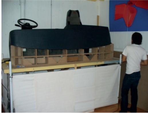
La utilidad de dicho simulador consistía en ubicar física y tangiblemente los diversos elementos que compondrían el área de interacción del operario del autobús a fin de verificar la visibilidad y alcance que éste tendría hacia los diferentes instrumentos, así como el alcance visual hacia el exterior, factor determinante para mejorar las condiciones y delimitado por los lineamientos técnicos de la ANPACT (2011).
